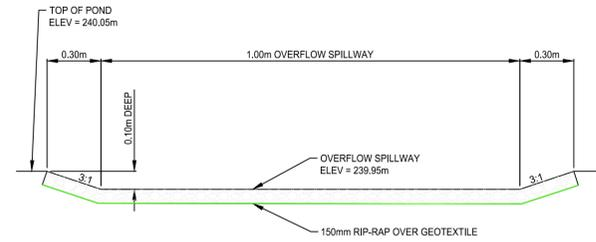
**1** TYPICAL OVERFLOW SPILLWAY
